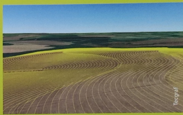
Desenho prévio das linhas permite quantificar as sobreposições, o tempo e as manobras realizadas pelas máquinas em campo
